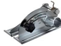
Der Tiefenanschlag mit Absaugstutzen ermöglicht ein staubarmes Trocken-Trennen von mineralischen Baumaterialien an ebenen Flächen. Exakte und stufenlose Einstellung der Schnitttiefe möglich, für TSA 230.
