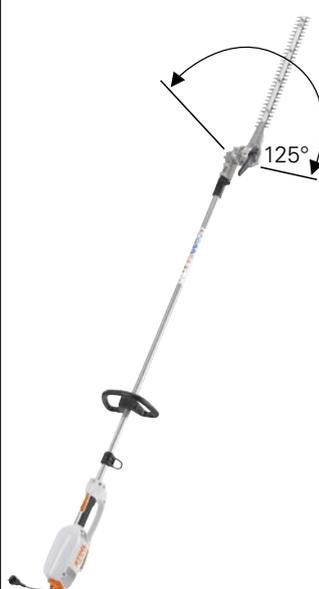
**230 V, 600 W, 5,9 kg<sup>④</sup>**. Optimal für den Schnitt hoher und breiter Hecken im lärmsensiblen Umfeld. Um 125° schwenkbarer Messerbalken, doppelseitig geschliffene Messer, Softgriff, Transportstellung, Überlastschutz, Kabelzugentlastung, Gesamtlänge 254 cm.
