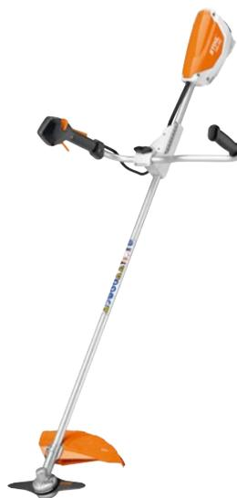
Leistungsstarke und leichte Akku-Motorsense für Flächenarbeiten in zähem Gras. Schneidkreis-Durchmesser 260 mm mit Grasschneideblatt, drei Leistungsstufen einstellbar, Zweihandgriff. Einhängenvorrichtung zum Tragen des Gerätes mit rückentragbarem Akku AR oder Tragsystem AP (Zubehör auf Seite 28), Gewicht 4,5 kg<sup>①</sup>.
