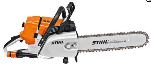
**76,5 cm<sup>3</sup>, 4,3 kW/5,8 PS, 7,6 kg<sup>①</sup>.** Kombiniert die Handhabung einer Motorsäge mit der Kraft eines Trennschleifers. Seitliche Kettenspannung, STIHL Antivibrationssystem, Wasseranschluss, Dekompressionsventil, STIHL ElastoStart, verschleissfestes Anwerfseil, HD2-Filter, stehend befüllbarer Tank mit Bajonett-Tankverschluss, 2-MIX-Motor.
