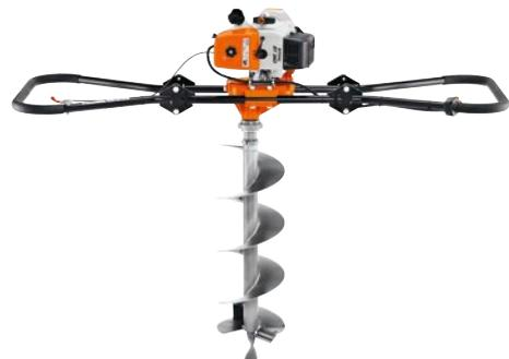
**60,3 cm<sup>3</sup>, 2,9 kW/3,9 PS, 28,8 kg<sup>①</sup>**. Bewährter durchzugsstarker Motor mit hohem Drehmoment für schwere Bohrarbeiten zu zweit. Serienmässig mit STIHL ElastoStart, Start- und Rückdreh Sperre, Langzeit-Luftfiltersystem, zusätzlichem Stoppschalter für den zweiten Bediener, klappbarem Rahmen.
