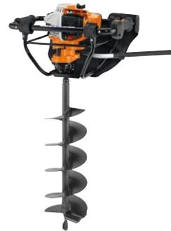
**36,3 cm<sup>3</sup>, 1,4 kW/1,9 PS, 10,0 kg<sup>①</sup>**. Einmann-Bohrgerät mit QuickStop-Bohrerbremse. 4-MIX<sup>®</sup>-Motor mit vergrößerter Kraftstofftank, vibrationsgedämpfter Griffrahmen, Bediengriff mit Stopptaster, Langzeit-Luftfiltersystem, grosses Anlagepolster.
