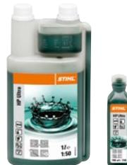
Vollsynthetisches Öl für den Dauereinsatz bei höchsten Anforderungen. Hervorragende Schmiereigenschaften, rückstandsarme Verbrennung, biologisch abbaubar (über 60 % nach OECD 301 B), besonders schwefelarm, JASO-FB, ISO-L-EGB, Mischungsverhältnis 1 : 50.
