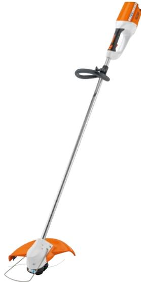
Akku-Motorsense für Mäharbeiten entlang von Hindernissen sowie an Bäumen und Sträuchern. Schneidkreis-Durchmesser 350 mm, stufenlos einstellbarer Bügelgriff, werkzeuglose Griffverstellung, durch Tippen des Mähkopfs auf den Boden stellt sich der Mähfaden automatisch nach, stufenlose Drehzahlregulierung, Abstandsbügel, Gewicht 2,8 kg<sup>④</sup>.
