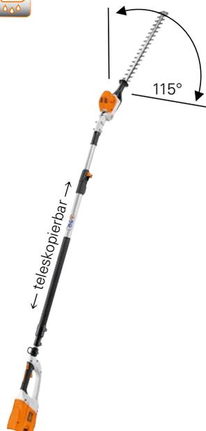
Akku-Heckenschneider für den professionellen Einsatz mit hoher Reichweite durch Teleskopschaft. Stufenlose Drehzahlregulierung, ideal einstellbar für Kopf-, Seiten- und Bodenschnitt, um 115° schwenkbarer Messerbalken, doppelseitig geschliffene Messer. Werkzeuglose Schaftlängeneinstellung durch Schnellspannhebel, Transportlänge 180 cm, Gesamtlänge 260–330 cm, Gewicht 4,4 kg<sup>③</sup>.
