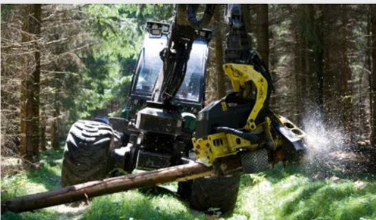
Sägekette für den Einsatz auf Spezialmaschinen in der maschinellen Holzernte und Brennholzerstellung, robust und langlebig. Reduzierte Spannungen führen zu geringen Rissbildungen bei geringem Verschleiss und besonders hoher Lebensdauer. **Darf nicht auf handgeführten Motorsägen eingesetzt werden.**
