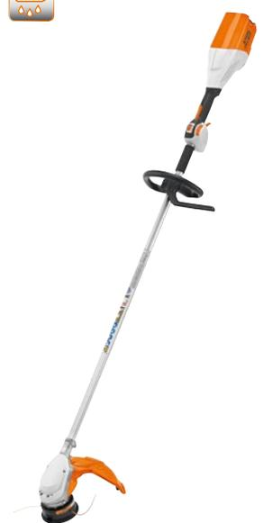
Akku-Motorsense für Flächenarbeiten in zähem Gras. Schneidkreis-Durchmesser 380 mm mit Mähkopf, Rundumgriff, Bediengriff mit Teillastfunktion ECOSPEED, Einfachtraggurt, Gewicht 2,8 kg<sup>④</sup>.
