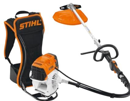
**36,3 cm<sup>3</sup>, 1,4 kW/1,9 PS, 9,6 kg<sup>Ⓞ</sup>**. Universell einsetzbar bei Mäharbeiten in schwer zugänglichem Gelände. Vereinfachter Startablauf für komfortables Starten, teilbarer Schaft für platzsparenden Transport, Multifunktionsgriff, Rundumgriff, 4-MIX<sup>®</sup>-Motor mit vergrößertem Tank für längere Laufzeiten, Stoptaster. Kombinierbar mit HL-KM, HT-KM, FH-KM, BG-KM, BF-KM, FCB-KM und FCS-KM.
