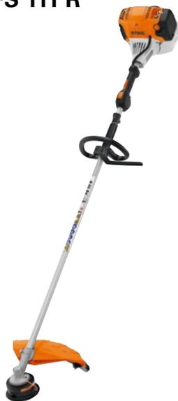
**31,4 cm<sup>3</sup>, 1,05 kW/1,45 PS, 5,5 kg<sup>Ⓞ</sup>.** Leistungsstarke Motorsense für Flächenarbeiten in zähem Gras. Vereinfachter Startablauf für komfortables Starten, Rundumgriff, Bediengriff mit Stopptaster, 4-MIX<sup>®</sup>-Motor mit vergrössertem Tank für längere Laufzeiten, starre Antriebswelle, Einfachtraggurt.
