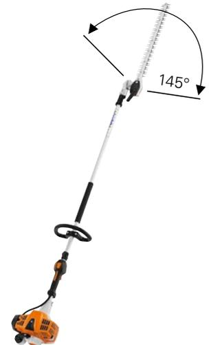
**24,1 cm<sup>3</sup>, 0,9 kW/1,2 PS, 6,1 kg<sup>Ⓞ</sup>.** Für professionelle Arbeiten an hohen Hecken und den Einsatz in Bodennähe. Gewichtsreduziertes Getriebe, 2-MIX-Motor mit ECOSPEED zur Drehzahlregulierung für lange Arbeitsintervalle in lärmsensiblen Bereichen, STIHL ErgoStart, um 145° schwenkbarer Messerbalken, Gesamtlänge 242 cm.
