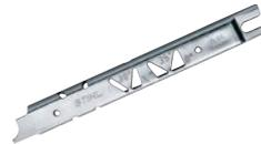
Zur Kontrolle von Brust- und Schärfwinkel, Zahnlänge und Tiefenbegrenzerabstand sowie zum Reinigen von Nut und Ölbohrung der Führungsschiene.
