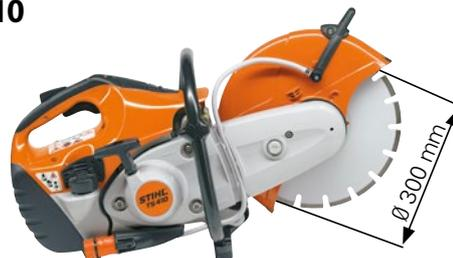
**66,7 cm<sup>3</sup>, 3,2 kW/4,4 PS, 9,5 kg<sup>Ⓞ</sup>**. Leichter und handlicher Trennschleifer. Mit 300-mm-Trennschleifscheibe für Schnitte bis zu 100 mm Tiefe. Das STIHL Antivibrationssystem gewährleistet eine gute Führung des Trennschleifers im Schnitt. Langzeit-Luftfiltersystem für eine lange Filterstandzeit, kräfteschonendes Anwerfen dank Dekompressionsventil, sparsamer 2-MIX-Motor.
