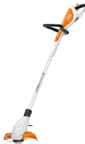
Kompakte Akku-Motorsense für einfache Trimm- und Ausputzarbeiten im hausnahen Bereich. Integrierter Lithium-Ionen-Akku (36 Wh) mit Ladezustandsanzeige, werkzeuglos einstellbarer Schaft und Bügelgriff, einstellbarer Arbeitswinkel der Mäheinheit u. a. für vertikales Kantenschneiden, einfacher Wechsel zwischen PolyCut-Messer und Mähfaden ohne Mähkopfwechsel, Abstandsbügel, Gewicht 2,3 kg<sup>①</sup>. Akku-Ladezeit 145 min/210 min (80%/100%).
