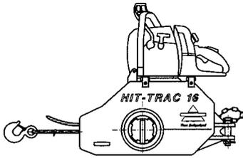
Mit beliebigen Seillängen einsetzbar bei gleichbleibender Zugkraft. Zu beziehen bei Habegger Maschinenfabrik AG, Thun
