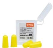
Aus konisch geformtem PU-Schaum mit sehr guten Dämmwerten. Weiches Material, passt sich dem Gehörgang angenehm an, zwei Paar in der Multibox, EN 352, SNR 33 (H: 32; M: 29; L: 29) (113 dB(A)).
