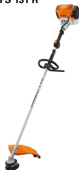
**36,3 cm<sup>3</sup>, 1,4 kW/1,9 PS, 5,5 kg<sup>Ⓞ</sup>.** Besonders leistungsstarke Motorsense für Flächenarbeiten in zähem Gras. Vereinfachter Startablauf für komfortables Starten, Rundumgriff, Bediengriff mit Stopptaster, 4-MIX<sup>®</sup>-Motor mit vergrössertem Tank für längere Laufzeiten, starre Antriebswelle, Einfachtraggurt.
