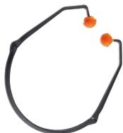
Extrem leicht (10 g), faltbar, EN 352, SNR 24 (H: 27; M: 20; L: 18) (bis 104 dB(A)), kein Drücken im Gehörgang durch aufliegende Form.
