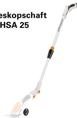
Ermöglicht das Arbeiten mit HSA 25 in aufrechter Haltung. Akkuwechsel im Bediengriff, stufenlos teleskopierbar von 95–110 cm, um 125° verstellbarer Arbeitswinkel, leichtgängige Rollen.
