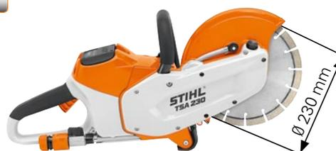
Handlicher Akku-Trennschleifer für 230-mm-Trennschleifscheiben. Innen und aussen einsetzbar, Schnitttiefe bis 70 mm, Wasseranschluss mit Kugelhahn und Schlauchkupplung zum Nass-Trennen, Spindelarretierung, wartungsfreier Riemenantrieb, Gewicht 3,9 kg<sup>②</sup>.
